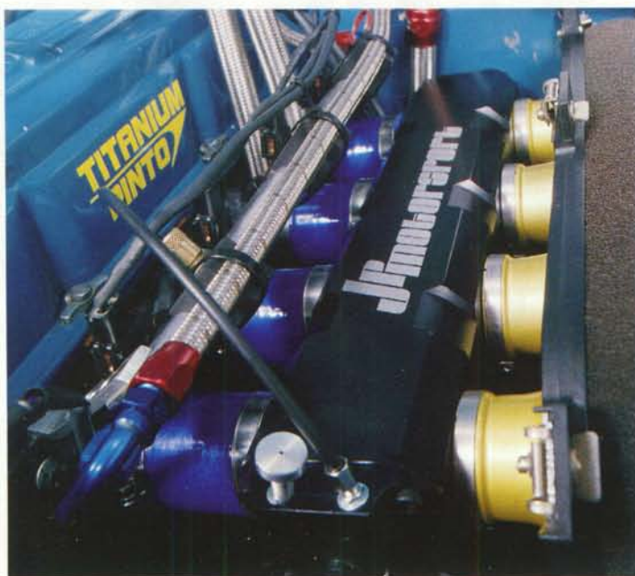
På insugssidan ser det lite annorlunda ut mot vad vi är vana vid. Inga Webrar. Bara JPM:s rullspjäll. Snyggt, som allt annat i Uffes bil. Killen har en otrolig puts på prylarna!
